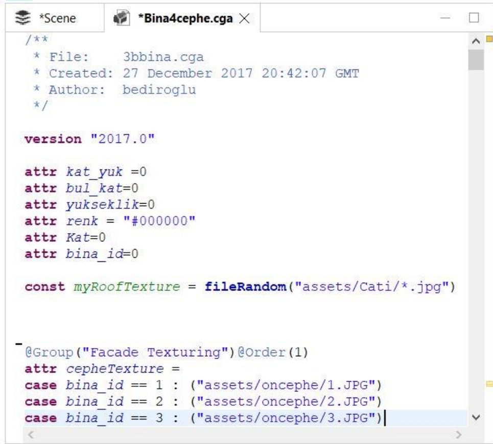
Şekil 58. CGA dilinde yazılan prosedürel model üretim kodlarının giriş bölümü
