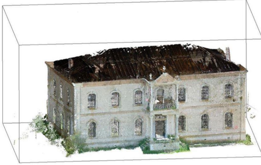
Şekil 20. Renklendirilmiş 3 boyutlu nokta bulutu verisi (Cömert vd., 2012)
