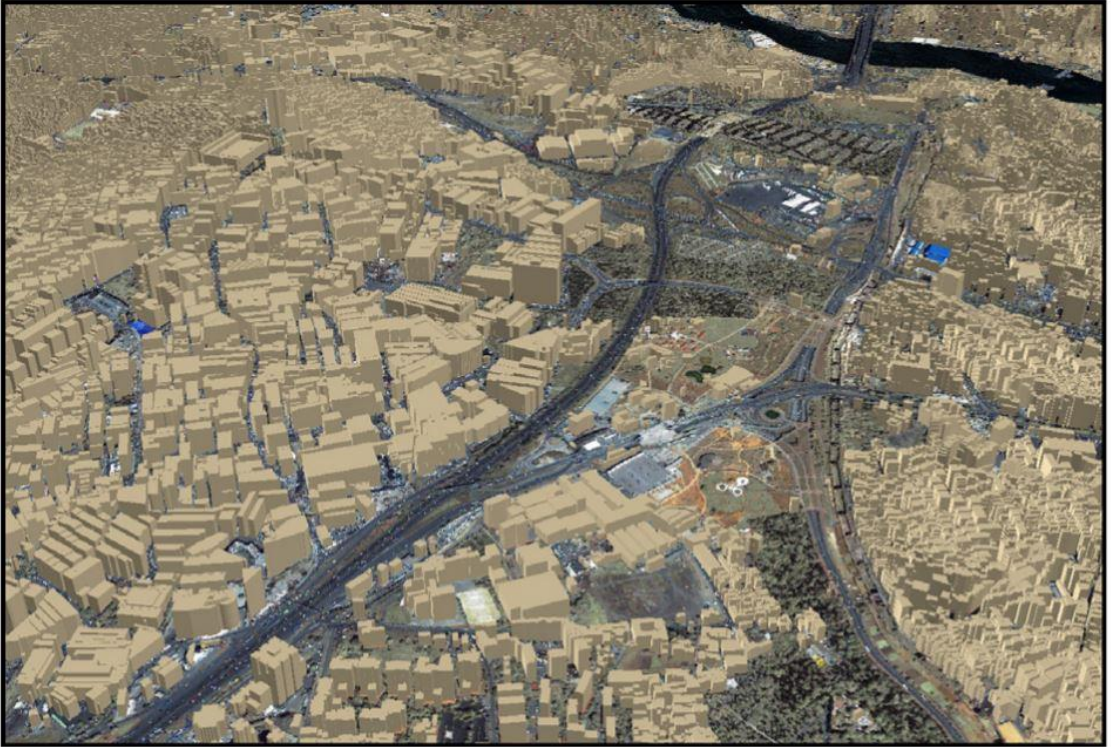
Şekil 8. Fotogrametrik yöntemler ile detay çıkarımı yapılmış solid 3B kent modeli (Tack vd., 2012)
