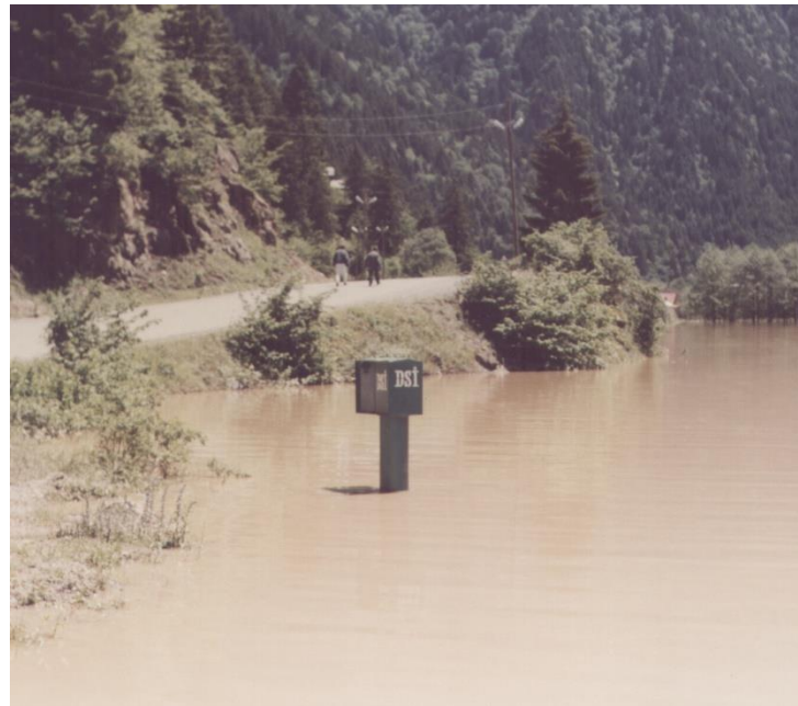
Şekil 13. Göl etrafında istinat duvarları yapılmadan önce limnigrafın bulunduğu noktada taşkın durumunda su seviyesi
