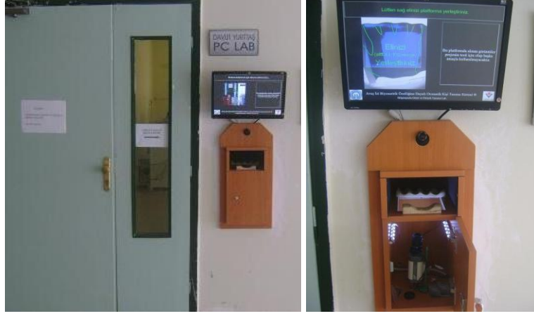
Şekil 2.5. Elektronik Müh. PC laboratuvarında hizmet veren çevrimiçi avuç izi doğrulama sistemi (KTÜ Sistem-2).
