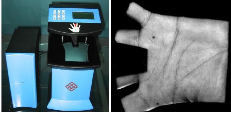
Şekil 1.3. Zhang vd. tarafından geliştirilen ilk çevrimiçi sistemin görünüşü (solda) ve bu sistemle elde edilen bir avuç görüntüsü (sağda) [14].
