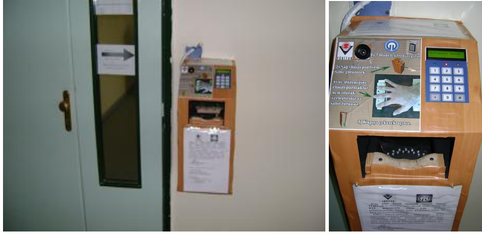
Şekil 2.3. Elektronik Müh. PC laboratuvarında kullanılan ilk çevrimiçi avuç izi doğrulama sistemi.
