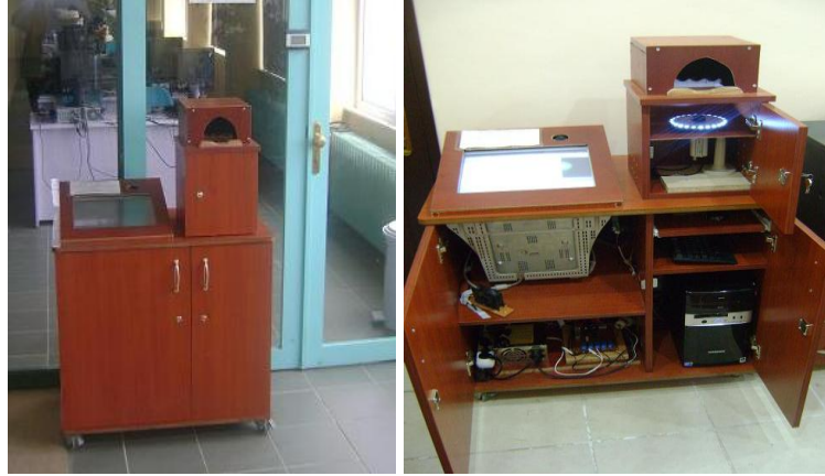
Şekil 2.4. İnşaat Müh. Bölümü PC laboratuvarında kullanılan çevrimiçi avuç izi doğrulama sistemi (KTÜ Sistem-1).
