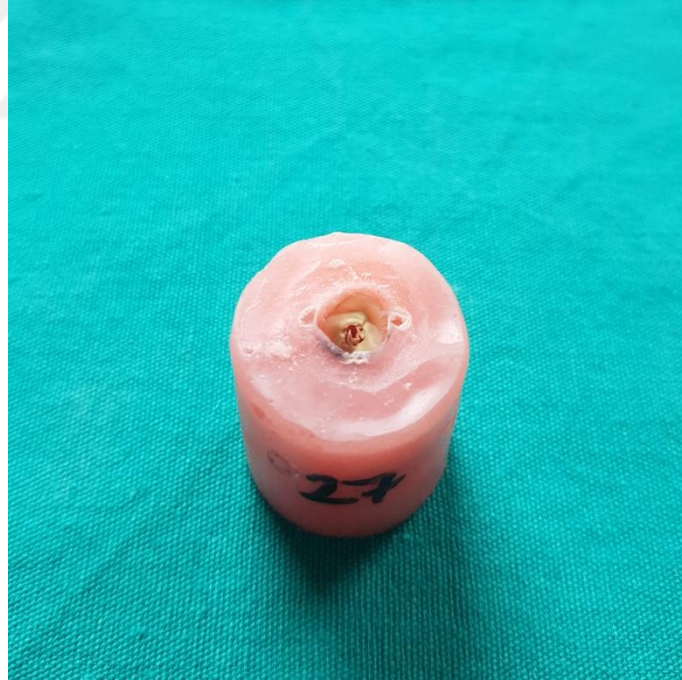
Resim 25. Akrilik rezin seviyesinin altına uzanan tamir edilemez kırık tipi
