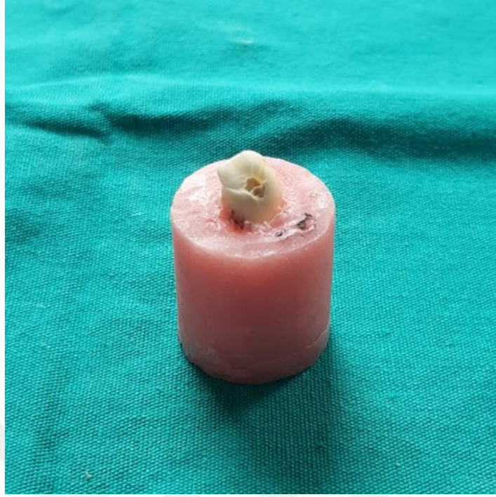
Resim 22. Akrilik rezin seviyesinin üzerinde tamir edilebilir kırık tipi
