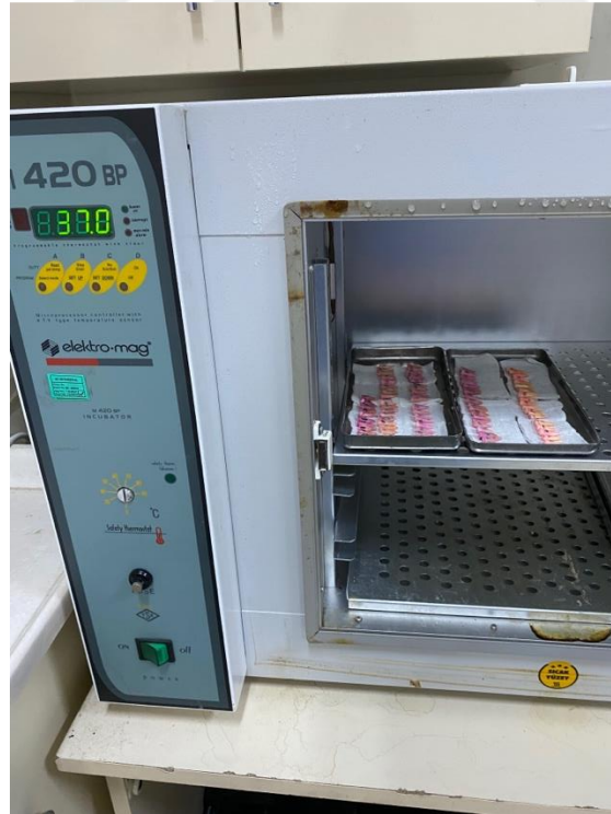
Resim 21. Kanal dolumu yapıldıktan sonra 37°C ve >%95 nemli olan inkübatör içerisinde örneklerin bekletilmesi
