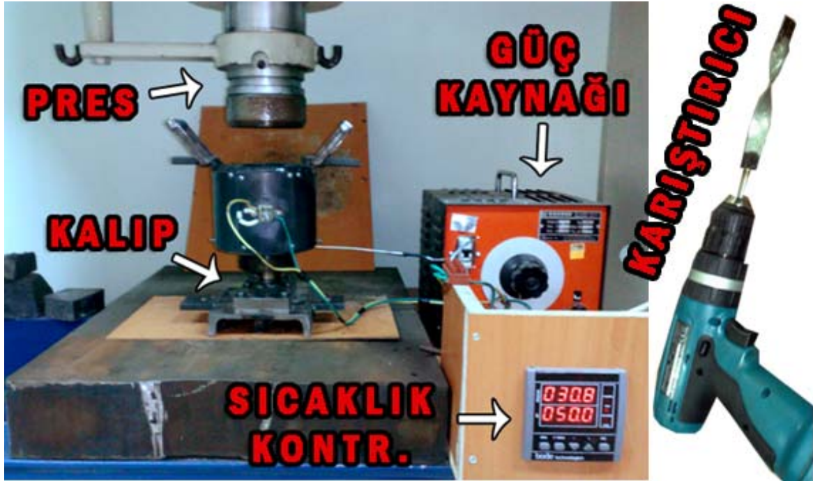
Şekil 2.6. Numune hazırlama kalıbı, sıcaklık kontrolörü, güç kaynağı ve karıştırma aparatı
