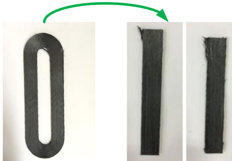
Şekil 26. Vakum ortamında üretilen üç noktalı eğilme test numuneleri
