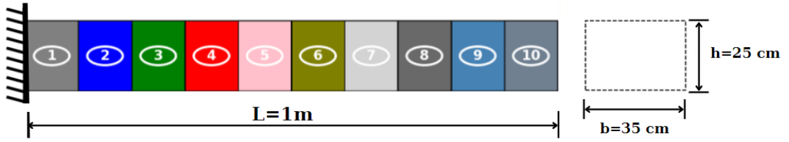
Şekil 7. Çalışmada kullanılan konsol kirişin sonlu eleman modeli
