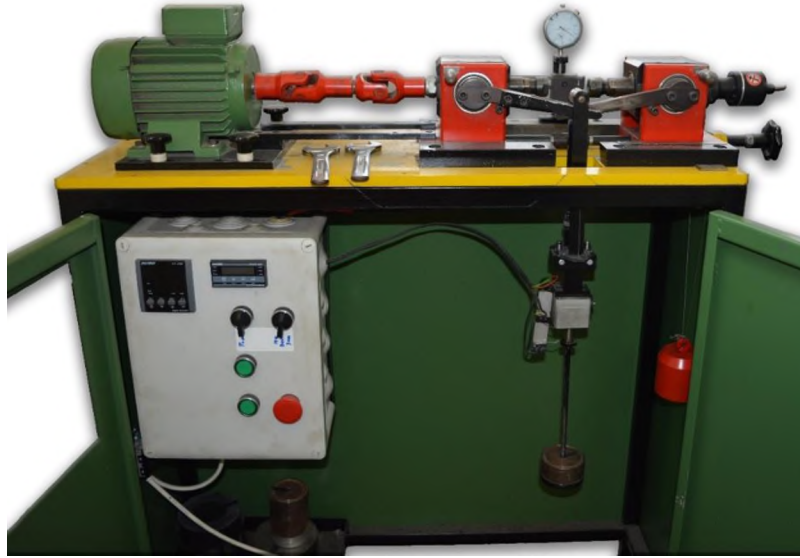
Şekil 7. Dönel eğmeli yorulma deney düzeneği
