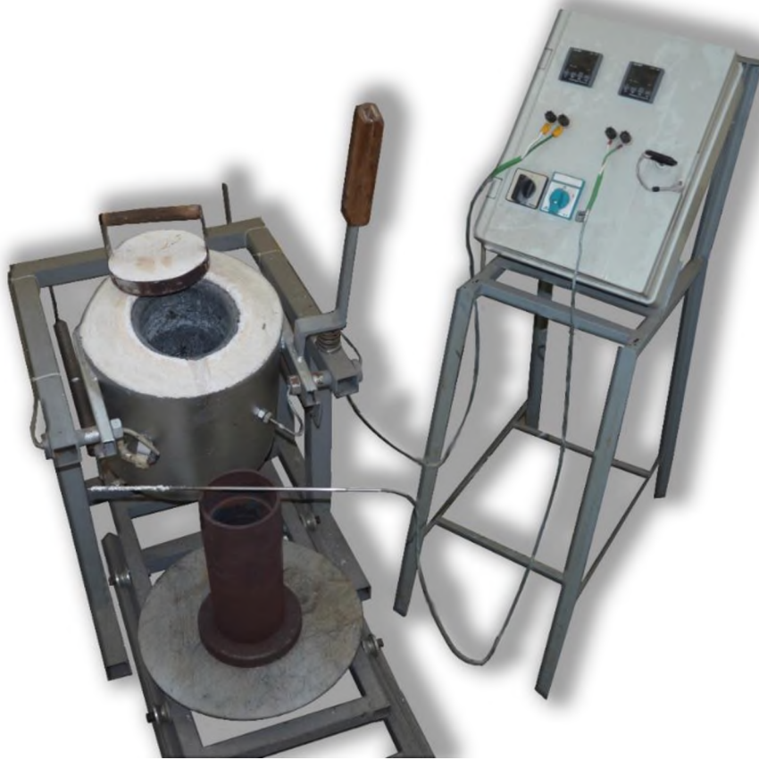
Şekil 4. Ergitme işleminin yapıldığı elektrikli pota fırını
