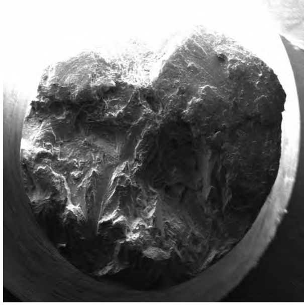
Şekil 23. 64 MPa’lık gerilmede yorulma deneyine tabi tutulmuş olan Zn-95Al alaşımasının yorulma numunesinin kırık yüzeyinin genel SEM görüntüsü
