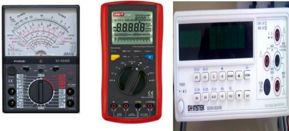
Resim 4: a) Analog Multimetre b) El tipi Digital Multimetre c) Masa Tipi Multimetre
