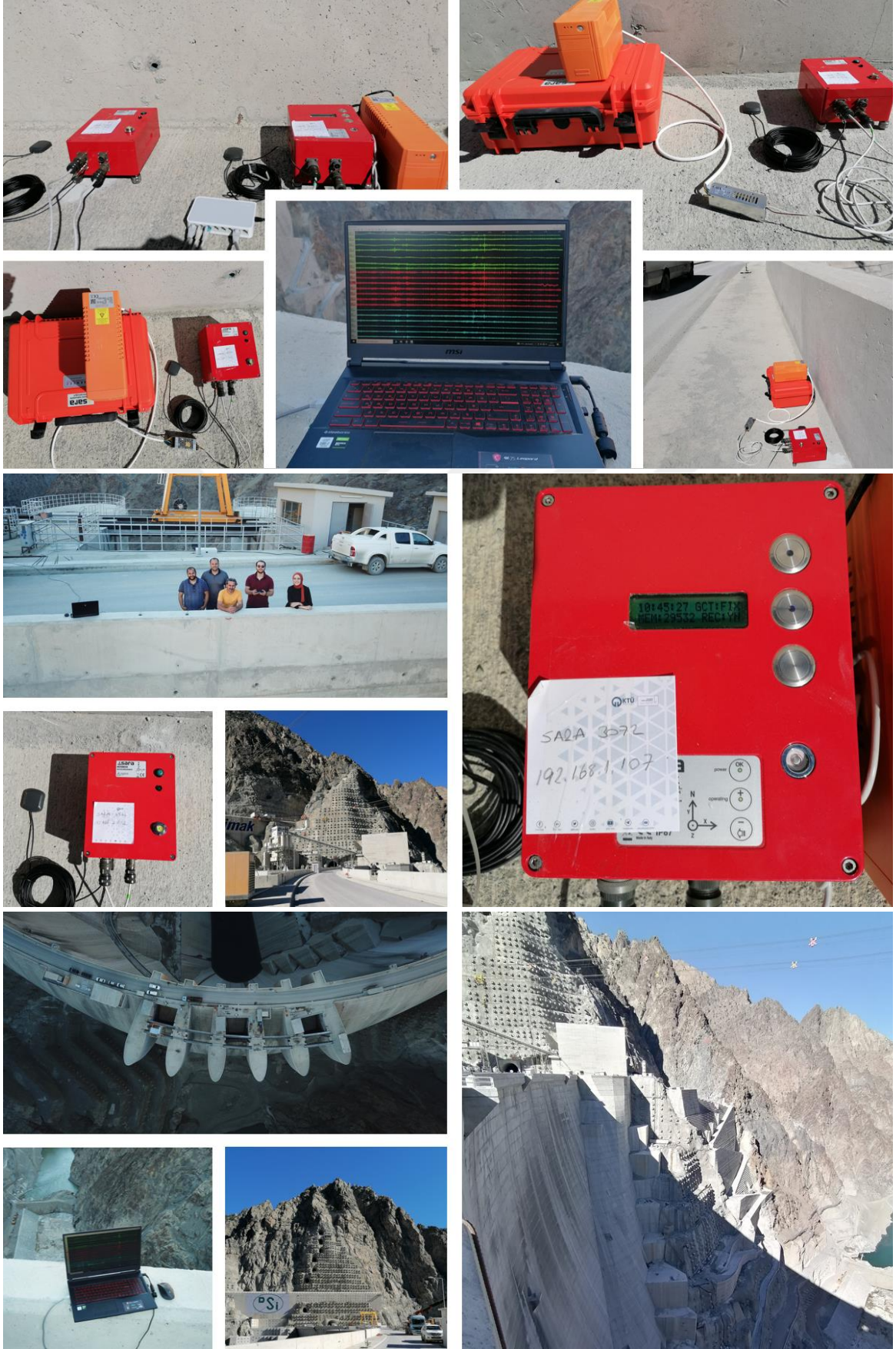
Şekil 36. Yusufeli Barajında yapılan çevresel titreşim testine ait bazı görseller
