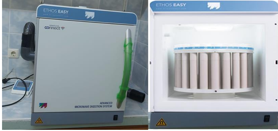
Şekil 27. PK'nin kimyasal analizi için kullanılan Ethos Easy Mikrodalga Çözündürme Ünitesi
