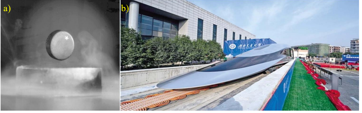
Şekil 20. (a) Bir külçe süperiletken üzerinde dengeli bir şekilde havada duran kalıcı mıknatıs (Hull, 2000), (b) Çin’de bir Maglev tren prototipi (Cheng vd., 2021).
