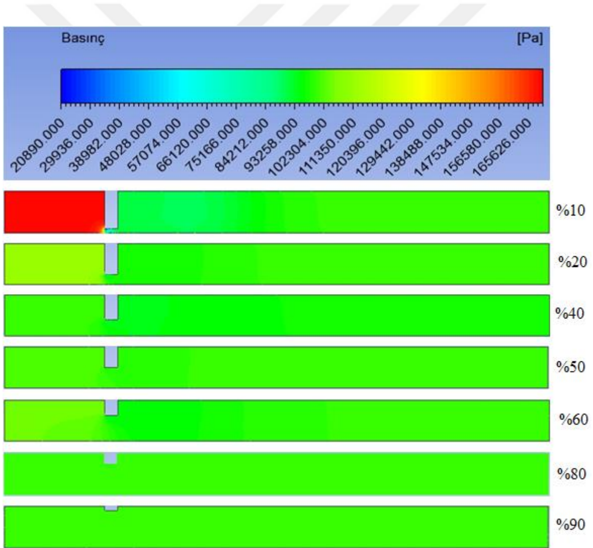
Şekil 3.7. Vana açıklık oranları için 1 m/s giriş hızına bağlı basınç dağılımları
