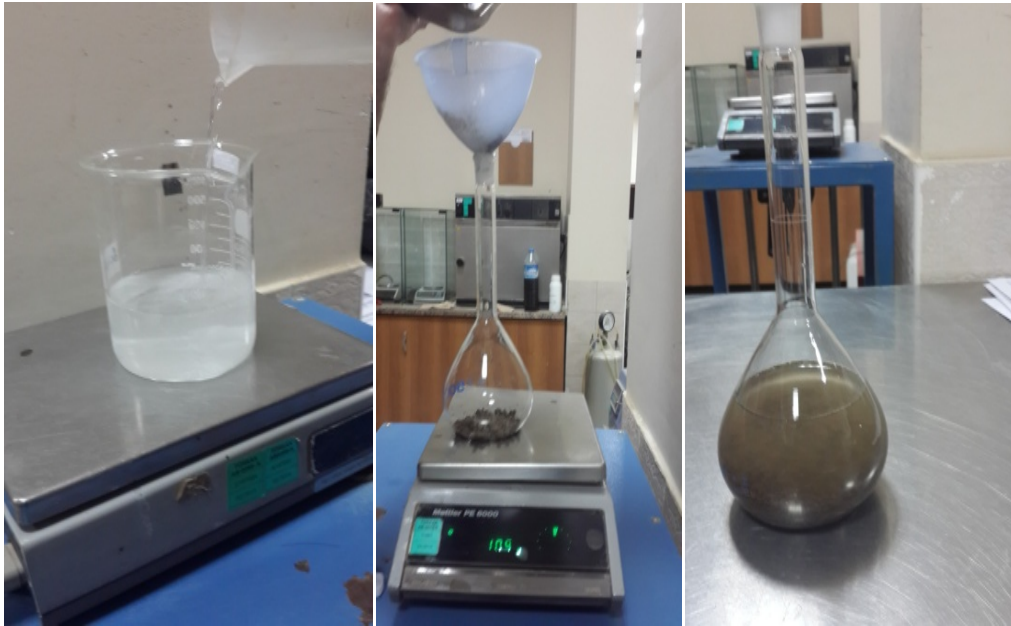
Şekil 2.5. Doğal malzemenin organik madde tayini için yapılan deney görselleri
