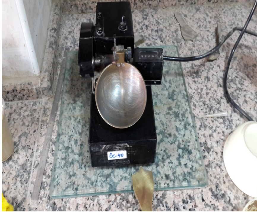
Şekil 2.9. Casagrande aleti ile likit limit değerinin belirlenmesi
