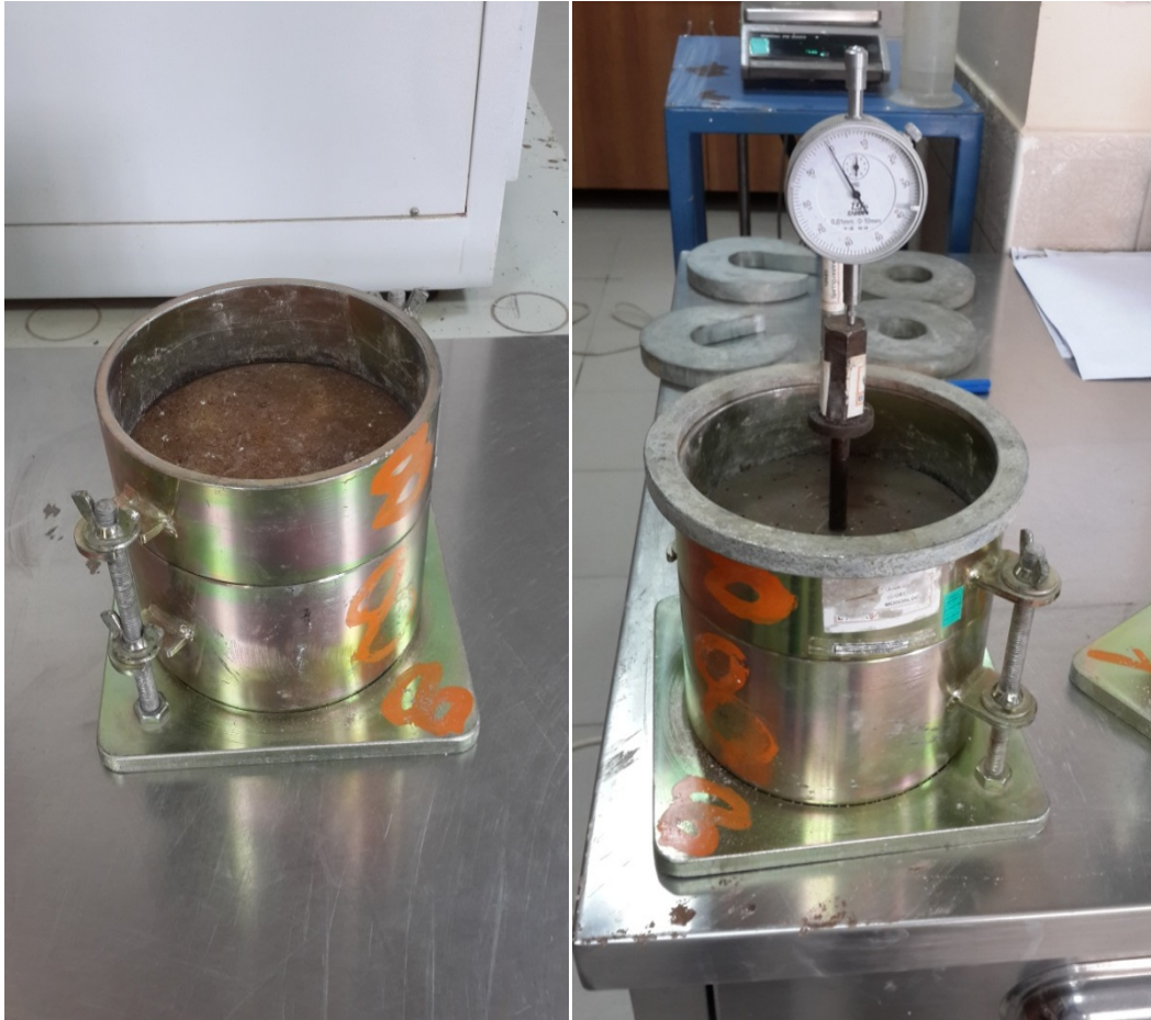
Şekil 2.1. CBR testi için numunelerin hazırlanması
