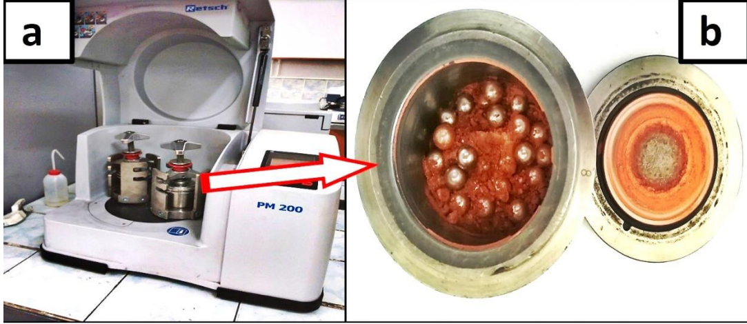
Şekil 39. Mekanik öğütme sistemi; mekanik öğütücü (a), öğütme haznesi, toz ve bilyeler (b)
