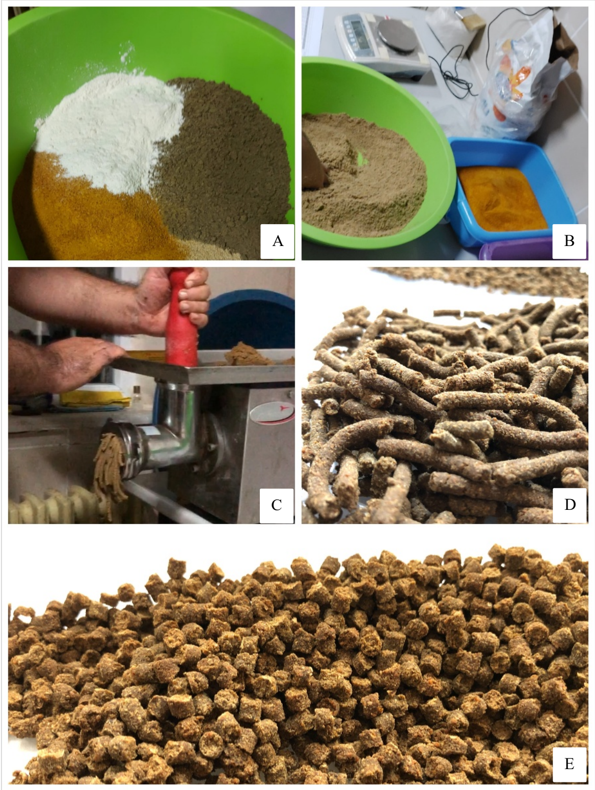
Şekil 6. Balık yemlerinin hazırlanması (A: hammadde, B: yoğurma işlemi, C: kıyma makinesi ile çekme işlemi, D: pelet halindeki yem, E: ufaltılmış yem)(orijinal)
