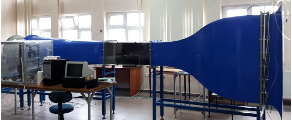
Şekil 2.2. Deneyde kullanılan rüzgâr tüneli test düzeneğinin görüntüsü
