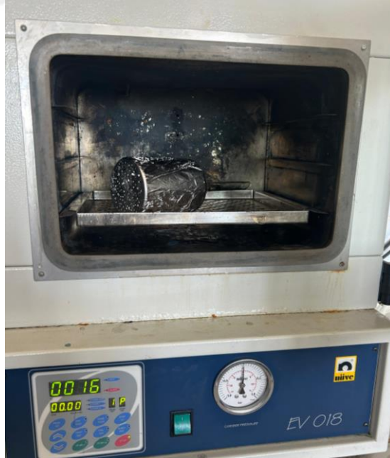
Şekil 32. PANI/PMMA-NP kompozitin gooch hunisi içinde etüve kurumaya bırakılması
