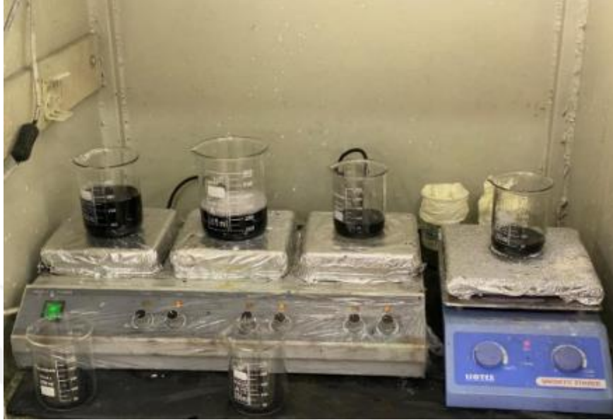
Şekil 21. PMMA/NP Kompozitlerin üretilme düzeneği
