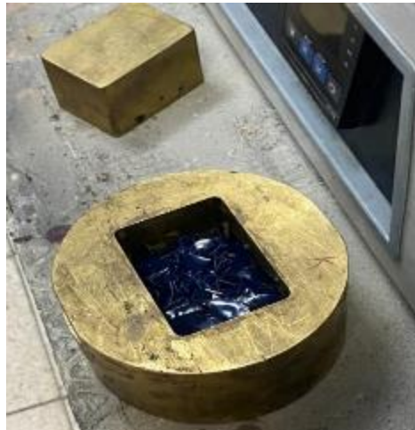
Şekil 24. Kalıp içine kırılmış PMMA/NP numunelerinin yerleştirilmesi
