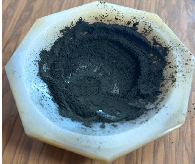
Şekil 19. Sentez sonucu elde edilen PANI toz
