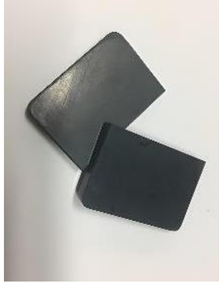
Şekil 26. Plaka haline getirilen PMMA/NP kompozitler
