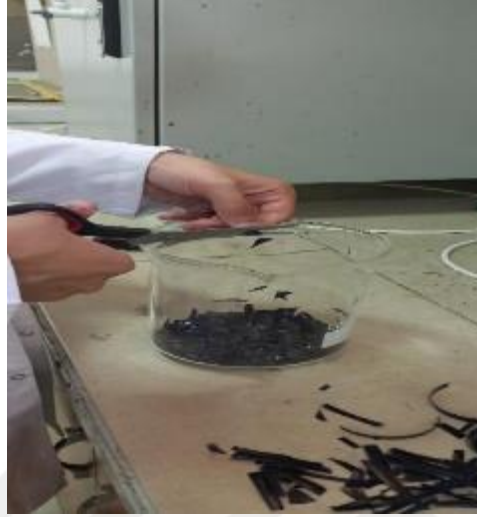
Şekil 23. Kuruyan PMMA/NP numunesinin kırılması
