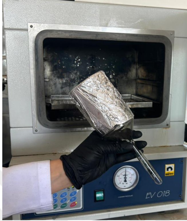
Şekil 18. Süzülen çözeltinin etüve bırakılması
