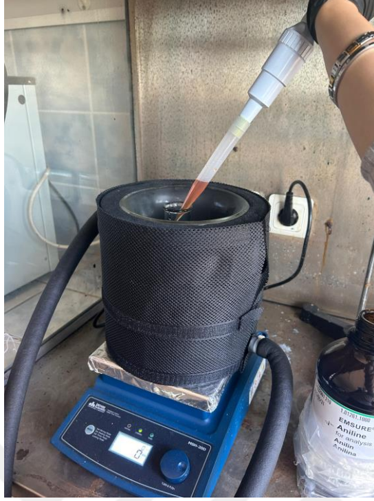
Şekil 28. Balon jojeye anilinin eklenmesi
