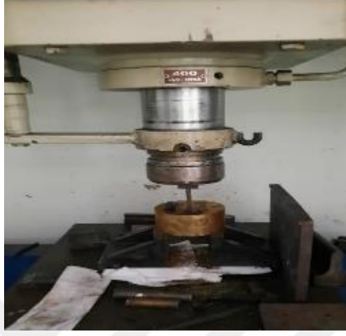
Şekil 25. Hidrolik pres ile PMMA/NP kompozitlerin kalıptan ayrılması
