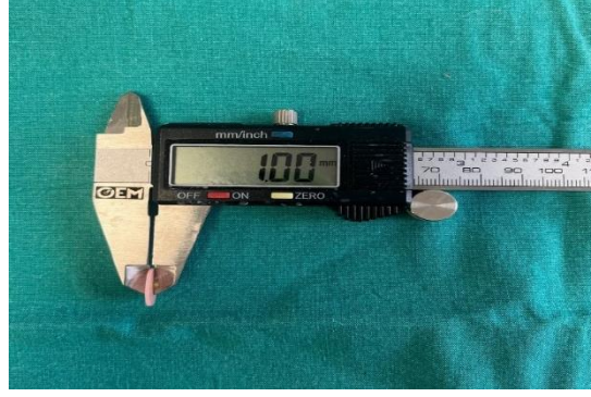
Resim 5. Dentin kesit kalınlığının dijital kumpas ile kontrol edilmesi
