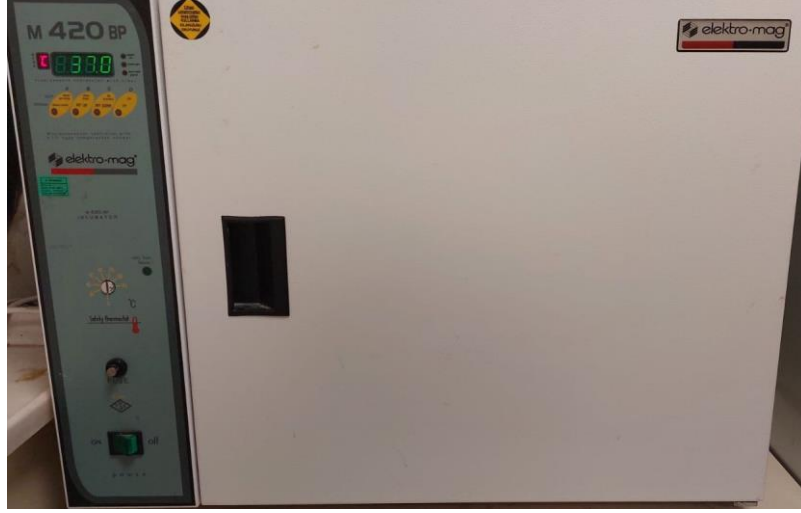
Resim 15. Dolum işleminden sonra, örneklerin 37°C sıcaklıkta ve >%95 nemli inkübatörde bekletilmesi
