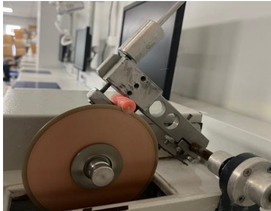
Resim 4. Hassas kesim cihazı ile örneklerden kesit elde edilmesi işlemi
