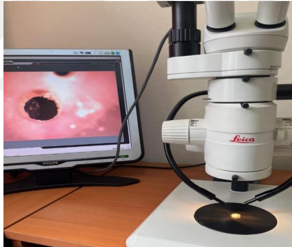
Resim 19. Başarısızlık tiplerinin stereomikroskop ile belirlenmesi
