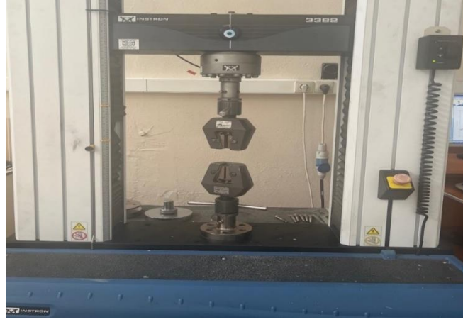
Resim 16. İtme bağlanma dayanımı testi için kullanılan universal test cihazı
