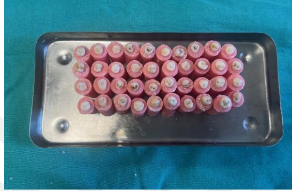
Resim 1. Soğuk akrille kalıp modellere gömülen dişler
