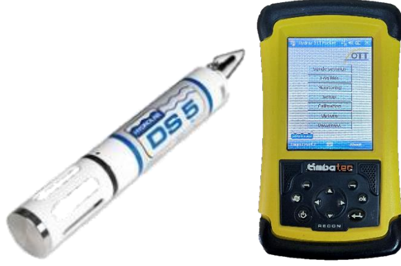
Şekil 42. Hydrolab DS5 ve bulanıklık ölçümlerinin kayıt edildiği el terminali
