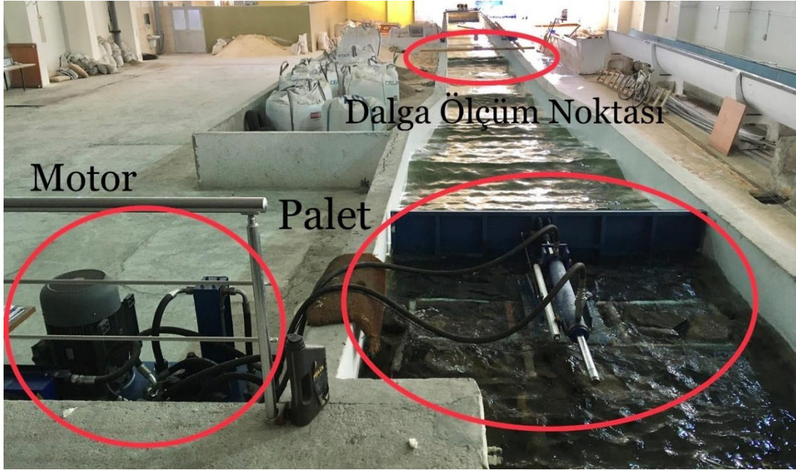
Şekil 16. Dalga üretim düzeneği ve dalganın üretilmesi
