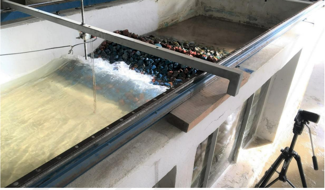
Şekil 22. Tırmanma ve aşma ölçüm sistemi
