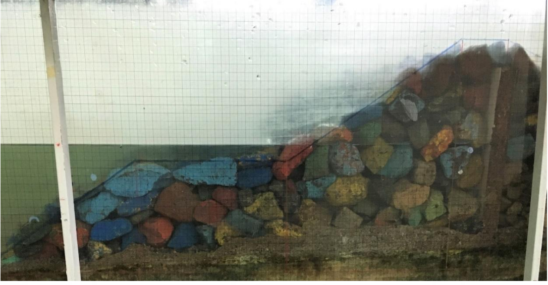
Şekil 38. B= 0.20 m ve \tan\alpha= 1/1.5 olan palyeli kıyı yapısı modeli kesitinin görünüşü
