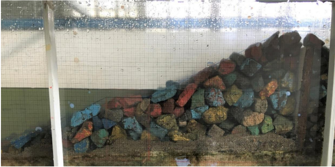
Şekil 26. B= 0.10 m ve \tan\alpha= 1/2 olan palyeli kıyı yapısı modeli kesitinin görünüşü
