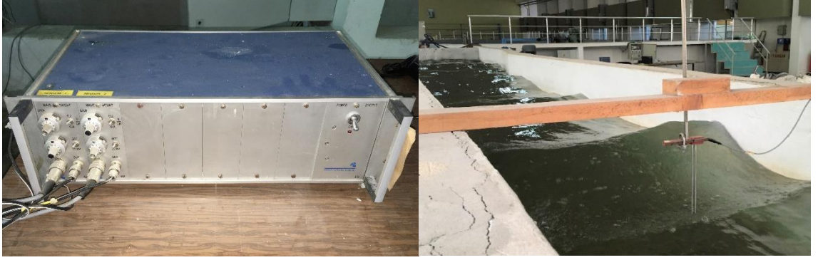
Şekil 18. Su seviyesi değişiklikleri ölçüm sistemi donanımları
