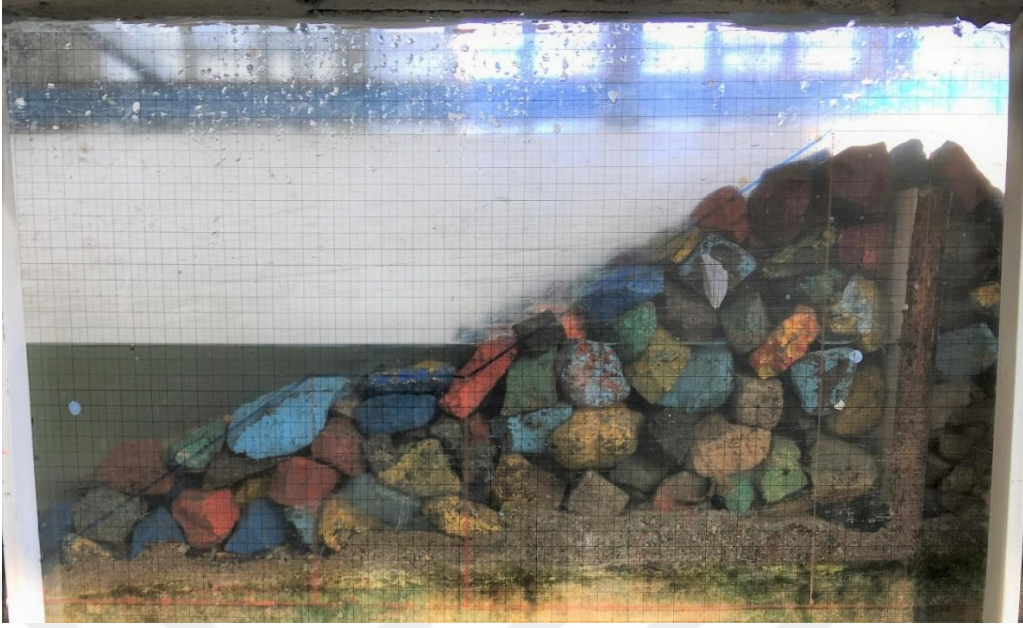
Şekil 34. B = 0.10 m ve \tan\alpha = 1/1.5 olan palyeli kıyı yapısı modeli kesitinin görünüşü
