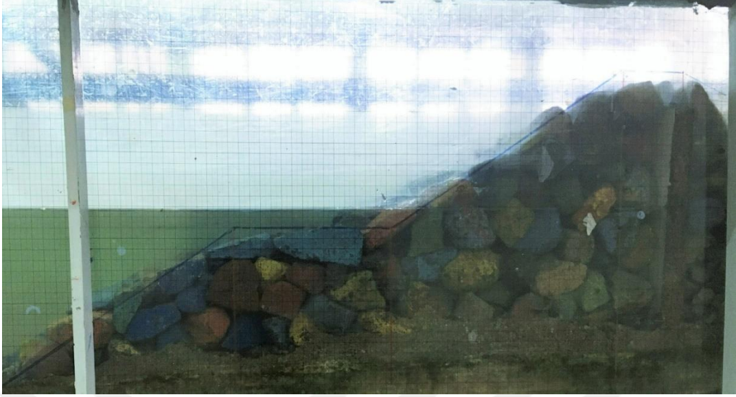
Şekil 36. B=0.15 m ve \tan\alpha= 1/1.5 olan palyeli kıyı yapısı modeli kesitinin görünüşü
