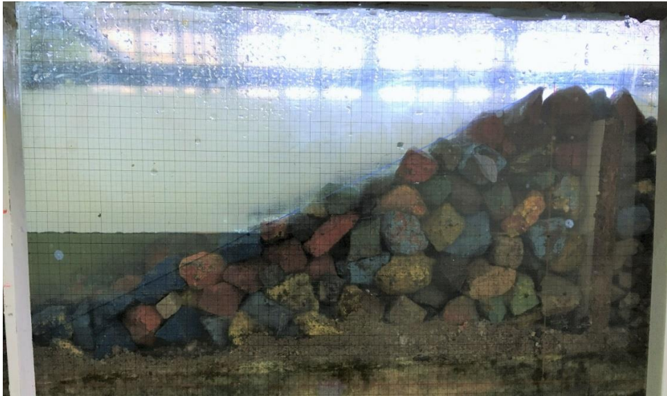
Şekil 24. B = 0 ve \tan\alpha = 1/2 olan geleneksel kıyı yapısı modeli kesitinin görünüşü
