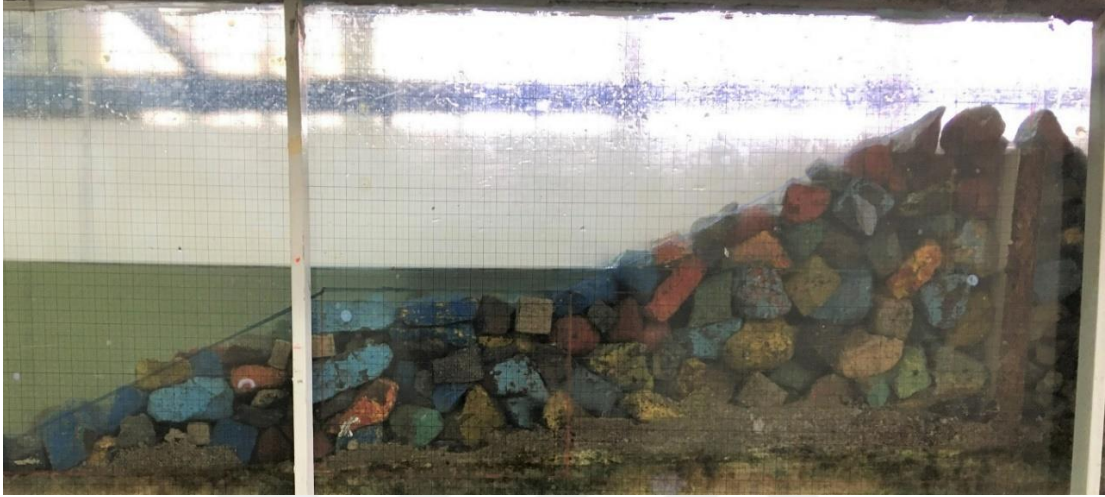
Şekil 30. B= 0.20 m ve \tan\alpha = 1/2 olan palyeli kıyı yapısı modeli kesitinin görünüşü
