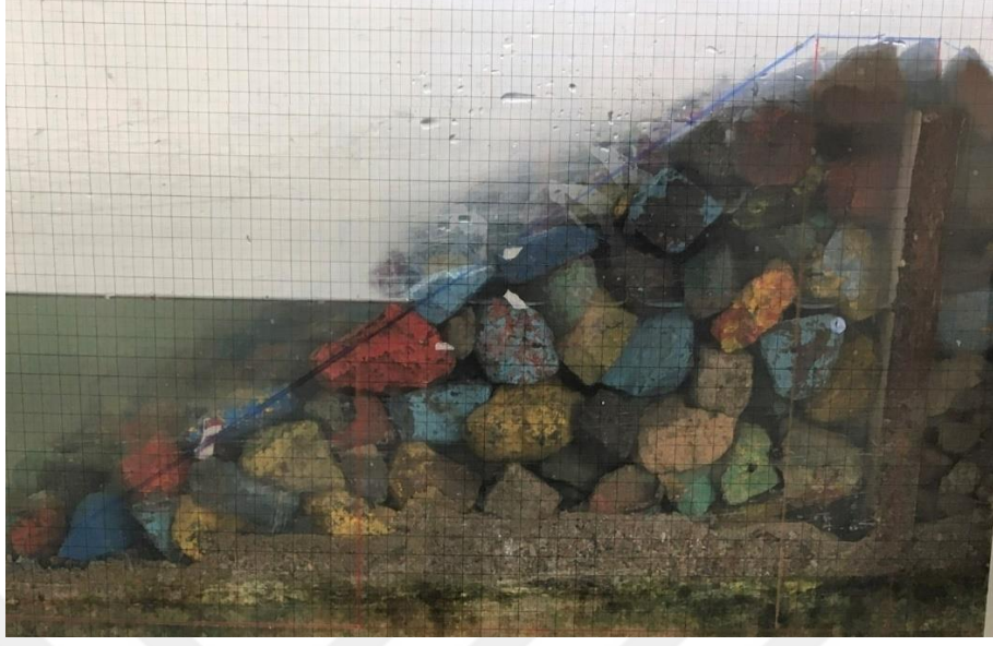
Şekil 32. B=0 ve \tan\alpha=1/1.5 olan geleneksel kıyı yapısı modeli kesitinin görünüşü
