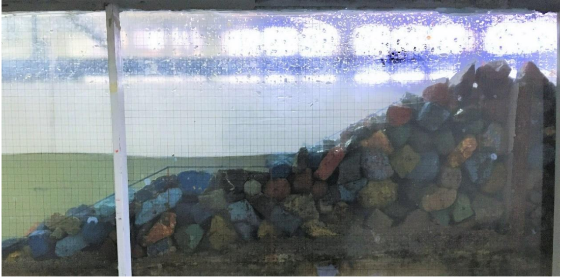
Şekil 28. B = 0.15 m ve \tan\alpha = 1/2 olan palyeli kıyı yapısı modeli kesitinin görünüşü
